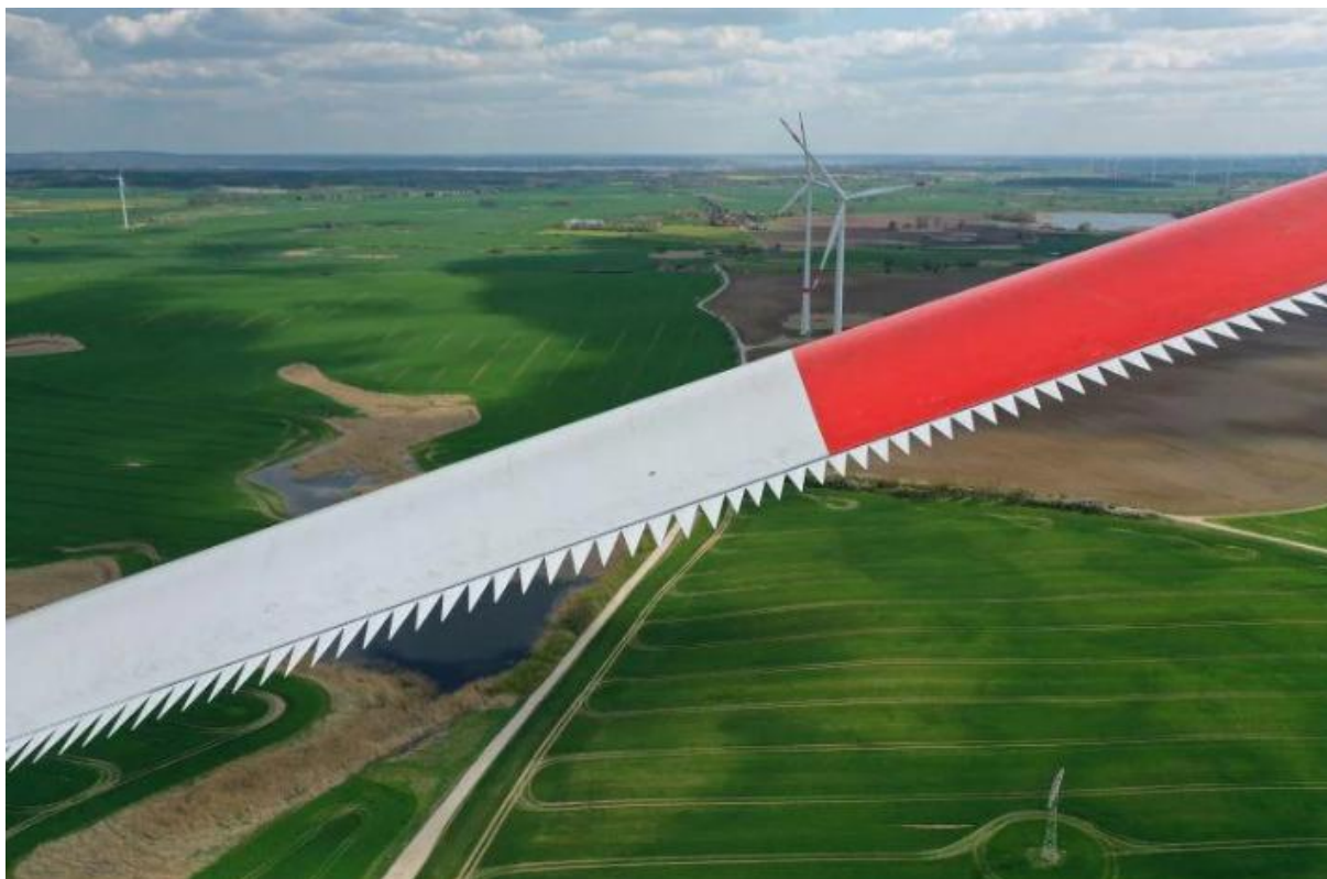
Obr. 3 Vroubkovaná odtoková hrana na VTE – příklad instalace
